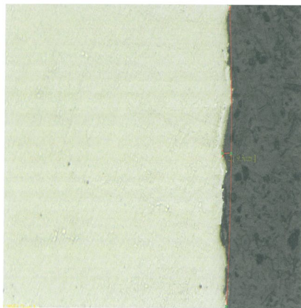
圖(3)加工後端面不良樣品 金相縱切面/缺陷深度量測
